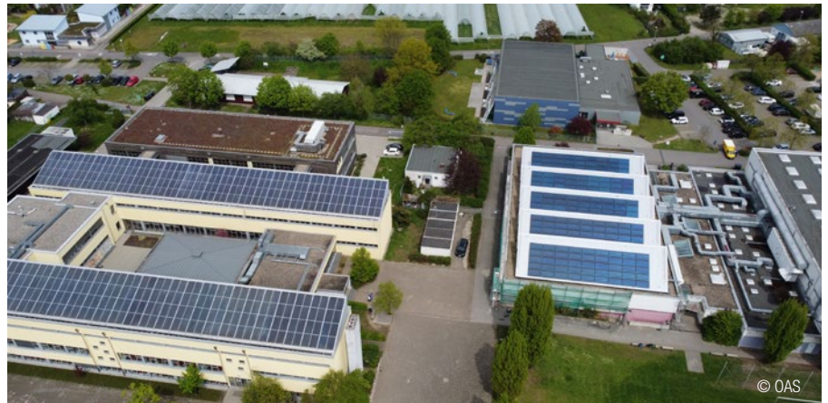
Im Schulzentrum Eggenstein-Leopoldshafen erzeugen Kollektoren auf einer Fläche von 1.600 qm mit Solarthermie Energie. In the Eggenstein-Leopoldshafen school center, collectors generate energy with solar thermal energy over an area of 1,600 square meters.
