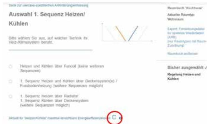
Figure 1: Part of an interview: AUTERAS asks about wishes regarding heating and cooling. At the same time, the energy efficiency class is calculated (here C, marked in red). Bild 1: Teil eines Interviews: AUTERAS fragt nach den Wünschen bezüglich Heizen und Kühlen. Gleichzeitig wird die Energieeffizienzklasse berechnet (hier C, rot markiert).
