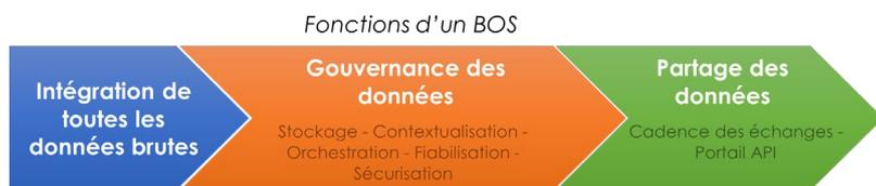
Fonctions assurées par le BOS (Building Operating System) pour agréger les produits, services et données en optimisant les flux d'information
