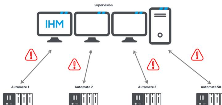
Infrastructure BACnet d'une application SCADA sans BACnet/SC
