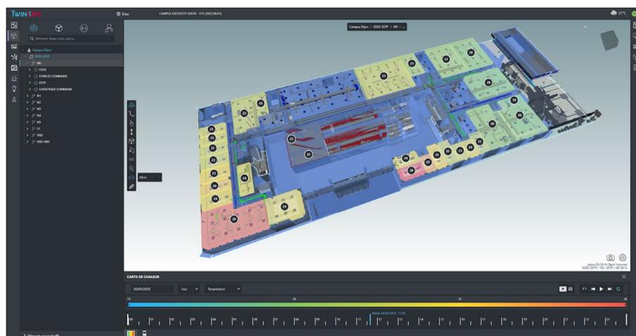
Exploitation du jumeau numérique de l'hyperviseur Twinops pour l'observation des niveaux de température ambiante des locaux
