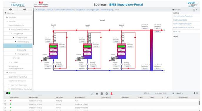
Heating monitoring: The properties' heating systems can be monitored in real time in the supervisor portal. Heizungs-Monitoring: Im Supervisor-Portal können die Heizungsanlagen der Liegenschaften in Echtzeit überwacht werden.
